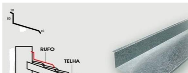
Figura 9 - Detalhe da instalação do rufo.
