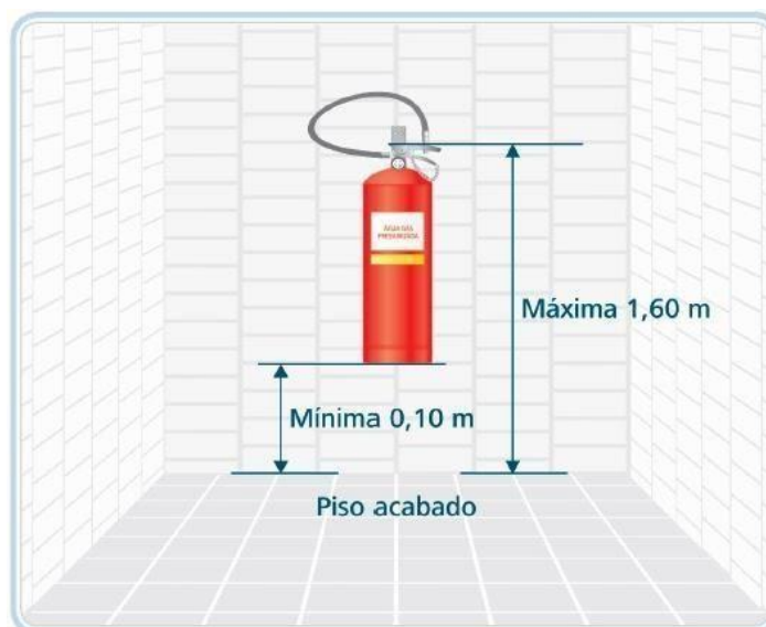
Figura 25 - Fixação extintor de incêndio
